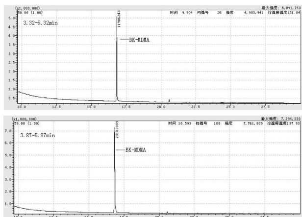
图7 空白尿标准添加 GPC 净化不同采集时间段的选离子流 (m/z58) 色谱图
